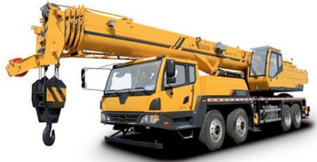
Crane self propelled dengan Boom Teleskopik
